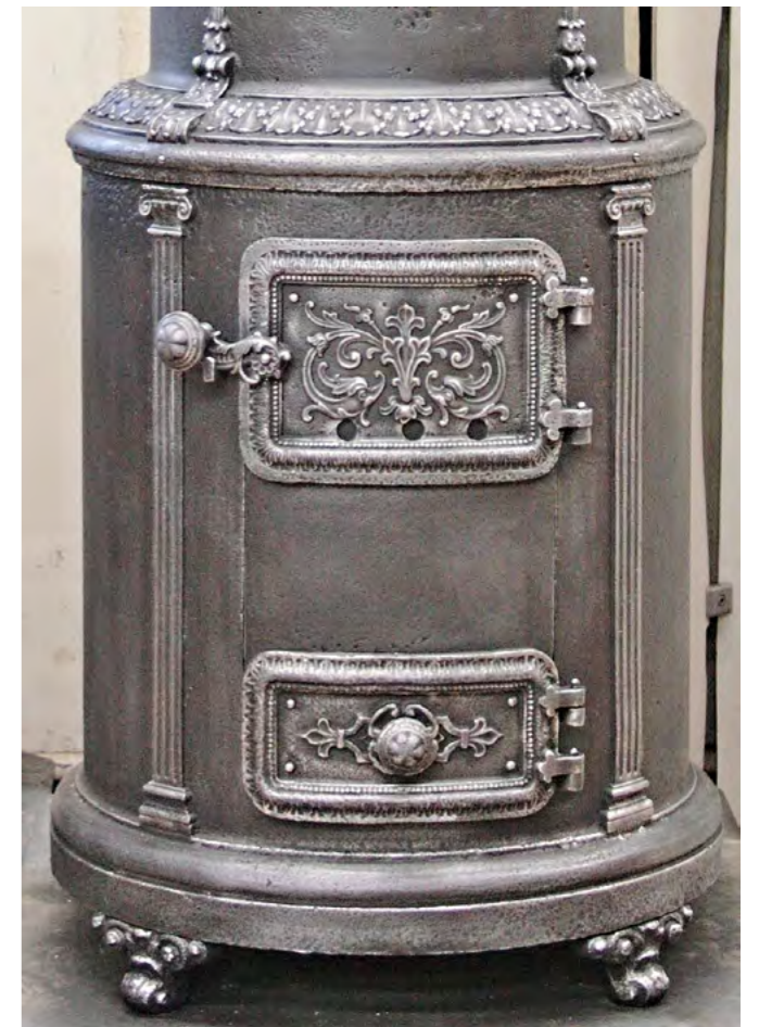
Äussere originale Gusstüre, durch einen mechanischen «Kunstgriff und Trick» unsichtbar aus zwei Türen zusammen verbunden
